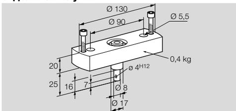
Монтажный комплект необходим, если привод монтируется с другим приводом клапана отличным от DKL, DKG, BVA, BVAF, BVG, BVGF, BVH, BVHS или VFC.
